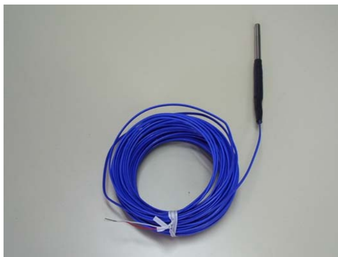
写真は K 熱電対温度センサー
